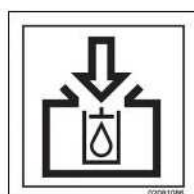
Llenado de depósito de aceite hidráulico
